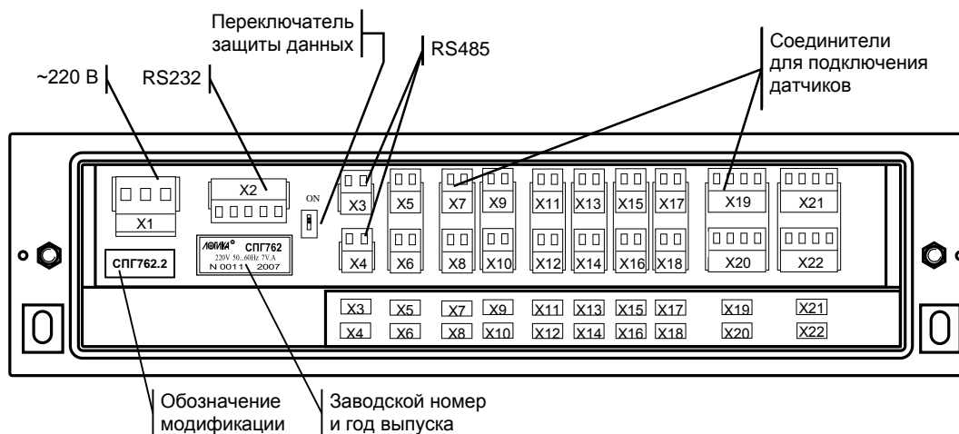
Рисунок 3.2 – Монтажный отсек (крышка снята)
